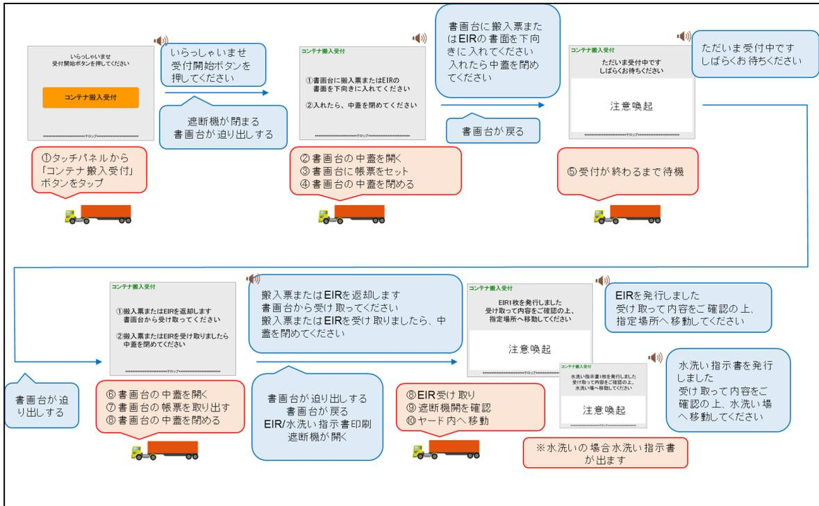
図⑥ 実入搬出受付 タッチパネル操作フロー
